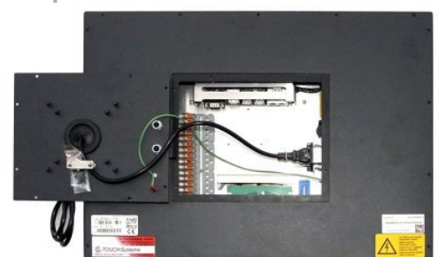
Geöffnete Tragarmklappe - mit Zugentlastung - Monitor Stecker und Tastenanschluss - mit integriertem Netzteil
