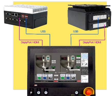
Umschaltung Videosignal + Touchfunktion zwischen 2 oder mehr FlatMan™ BOX-PCs
